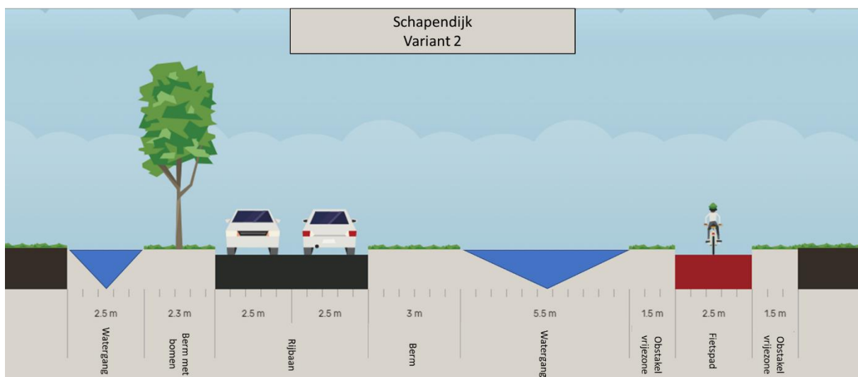
Figuur 8 Principe dwarsprofiel variant 2 Schapendijk (kijkrichting noord)
