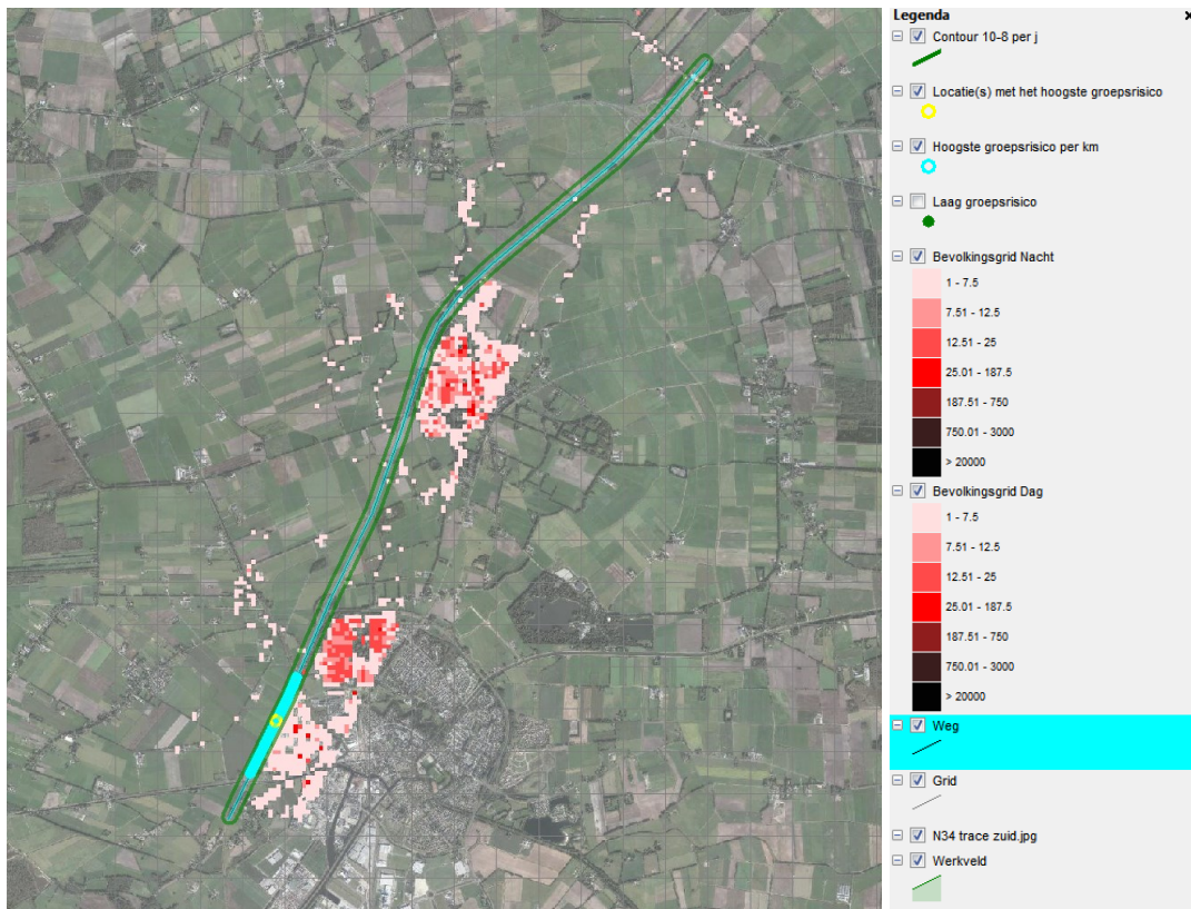
Figuur 5.1: N34 tracé zuid met bevolkingsgegevens en locaties met de hoogste Groepsrisico (geel rondje)
