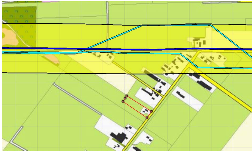
Figuur 6: Invloedsgebied van de aanwezige buisleiding A-577 (in geel), in rood plangebied bestemd voor recreatie
