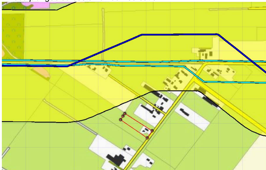
Figuur 8: Invloedsgebied van de aanwezige buisleiding A-594-03 (in geel), in rood plangebied bestemd voor recreatie
