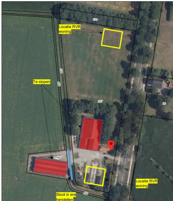
Detailopname van het plangebied. De te slopen gebouwen worden met de rode vlakken aangegeven. Met de gele lijnen wordt de begrenzing van de nieuw te bouwen woningen aangegeven (bron luchtfoto: pdok).
