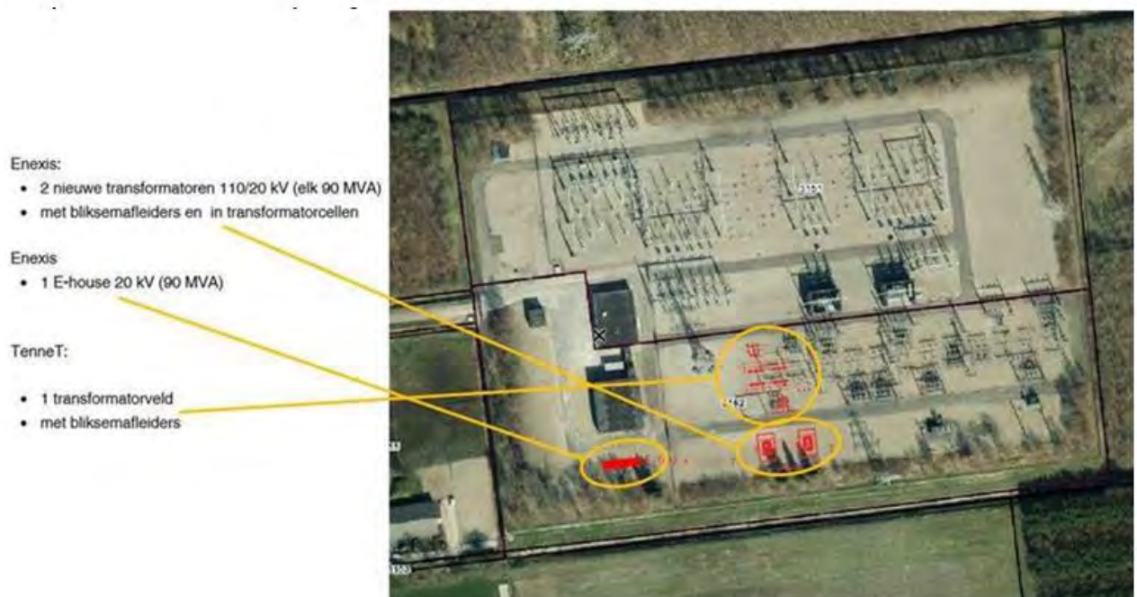
Figuur 1, beoogde uitbreiding HS/MS station Zeijerveen, fase 1
