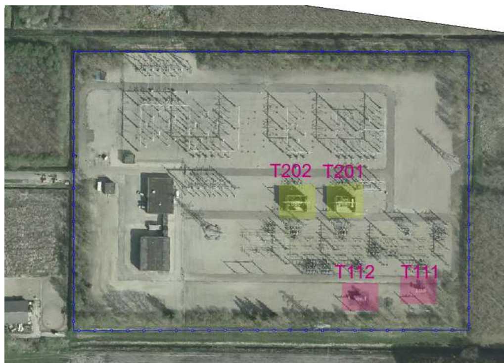
Figuur 3.4 huidige transformatoren op transformatorstation Zeijerveen
