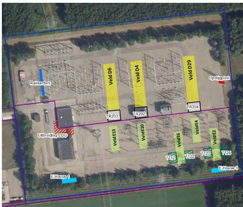
Figuur 2, beoogde uitbreiding HS/MS station Zeijerveen, fase 1
