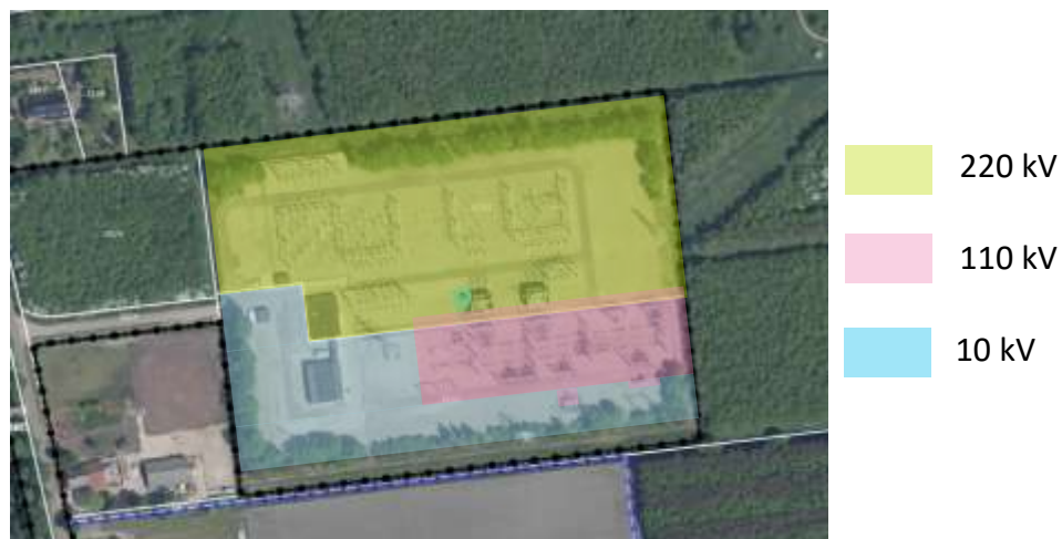
Figuur 3.3 Indeling terrein station Zeijerveen (spanningsniveau)
