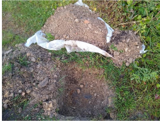
Foto 2: boring 18, met worteldoek zichtbaar
