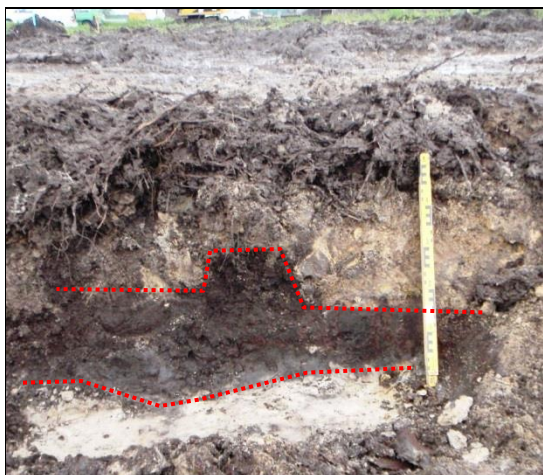
Afbeelding 8. Beeld van de bodemopbouw van deelgebied 2. Het veen bevindt zich tussen de rode lijnen
