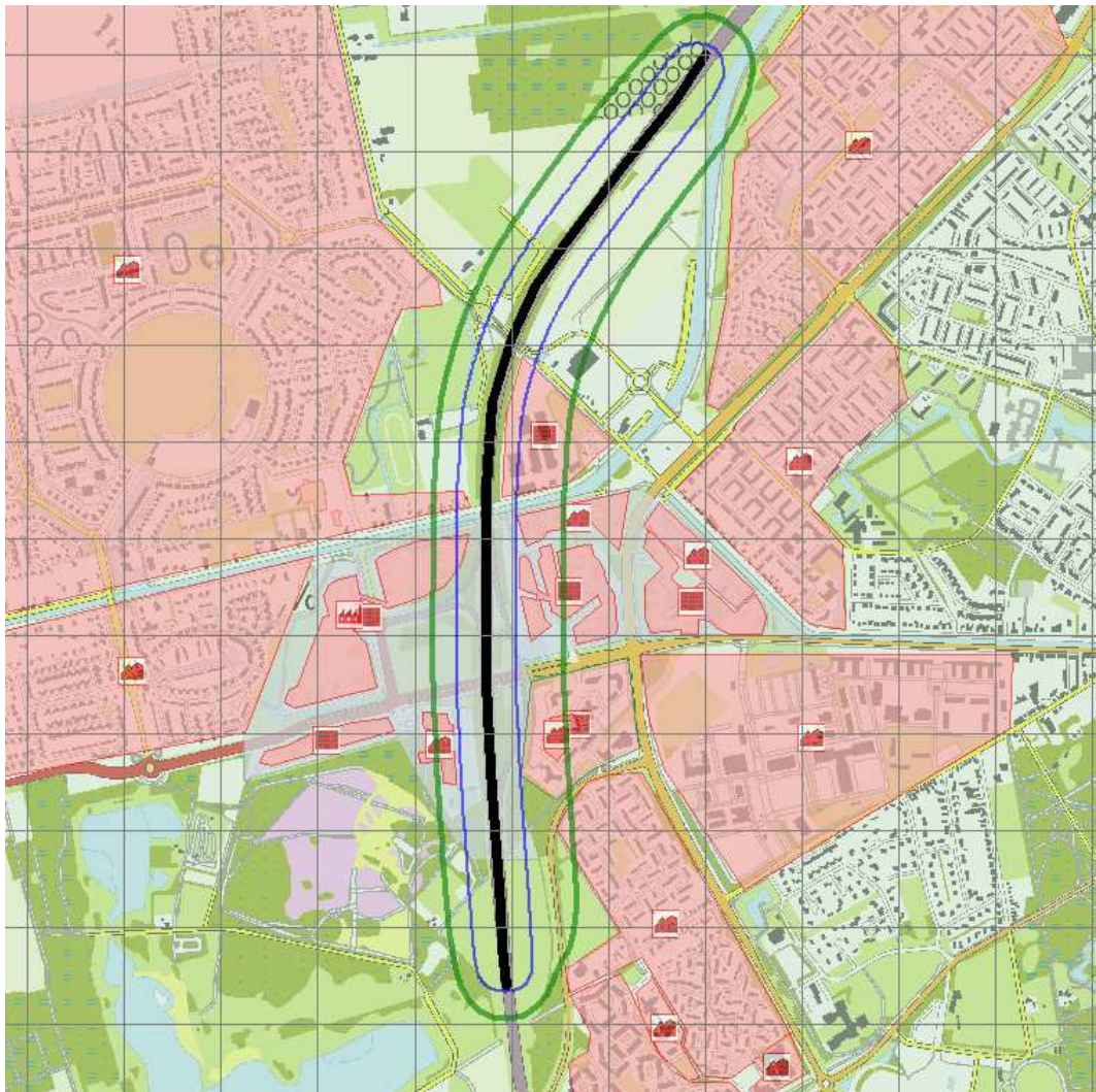
Figuur 4.1 PR10-7 (blauw) en PR10-8 (groen) risicocontour in gemodelleerde omgeving van de huidige situatie
