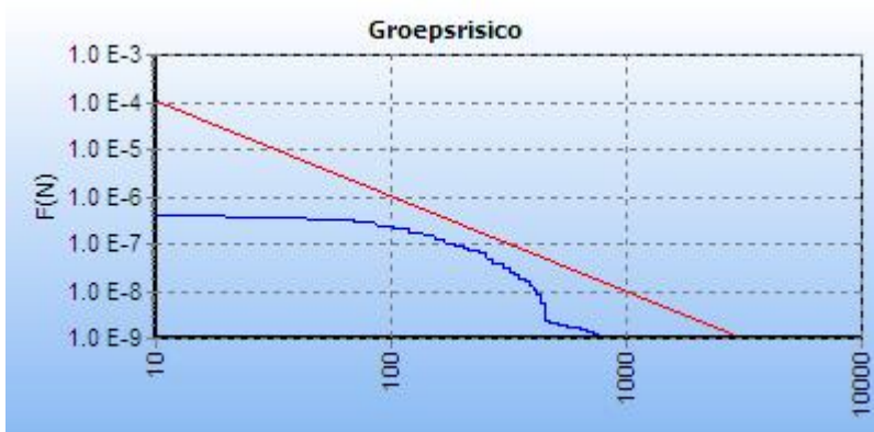
5.2 Figuur 5.2 FN curve voor {95652112-6439-472F-8831-17463BAAB3DB}_000142 van de NAM voor de kilometer tussen stationing 13790 en stationing 14790
