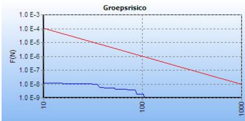
5.2 Figuur 5.2 FN curve voor {95652112-6439-472F-8831-17463BAAB3DB}_000142 van de NAM voor de kilometer tussen stationing 13790 en stationing 14790
