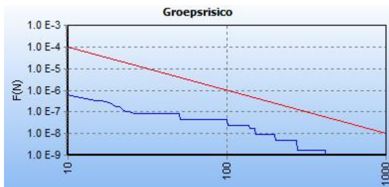
Figuur 5.4: fN-curve van het berekende groepsrisico (blauwe lijn) met de oriëntatiewaarde (rode lijn) voor de nieuwe situatie
