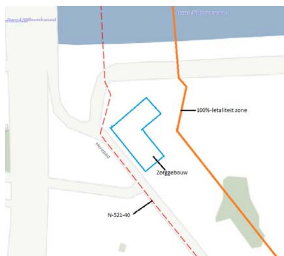
Figuur 5.4 : Gebied rondom de gasleiding waarbij sprake is van 100% letaliteit in geval van falen van de gasleiding
