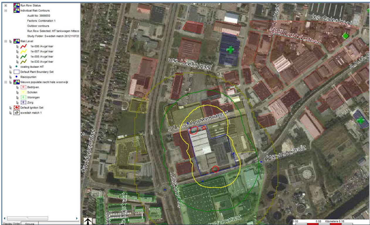
Figuur 7.14-1 Plaatsgebonden risico realisatie nieuwe woonwijk realisatie losplaats en opslag isobutaan op het achterterrein en het opwaarderen losplaats propaan met losarmen
