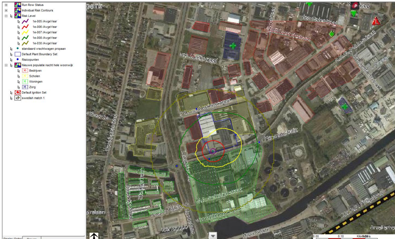
Figuur 7.5-1 Risico-contouren propaan losslangen, tankwagen met hitte werende coating
