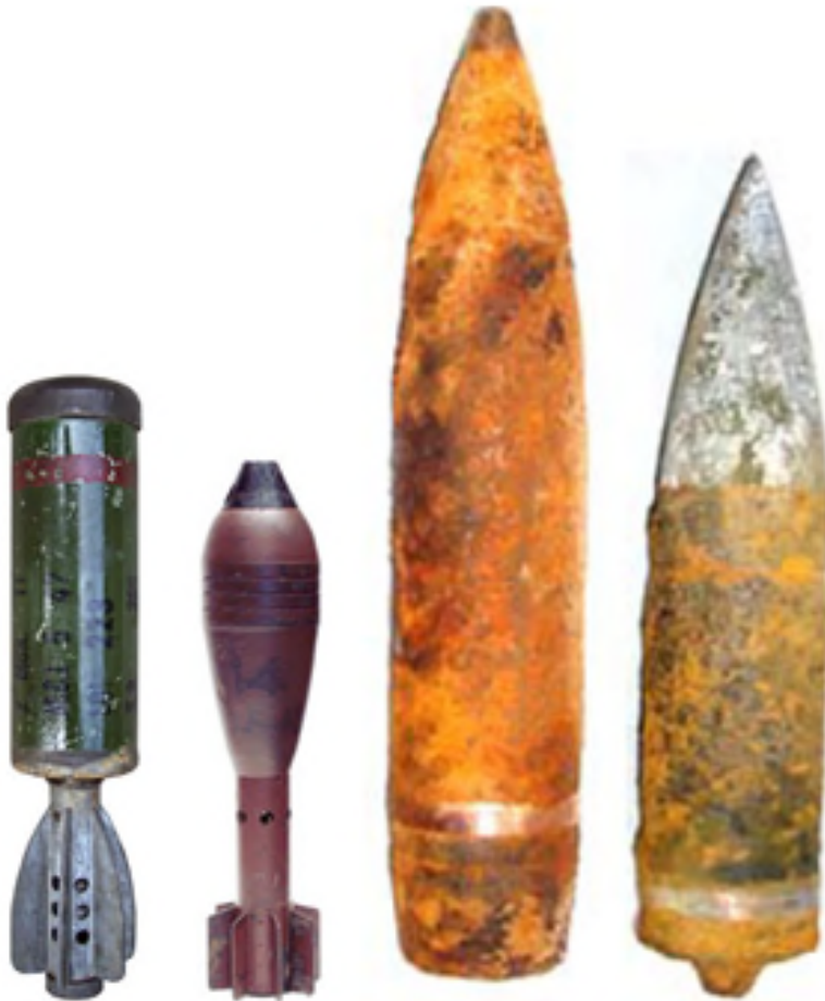
Figuur 19 Van links naar rechts: Britse Rookgranaat 2 inch mortier, Duitse Brisantgranaat 5 cm mortier, Amerikaanse Brisantgranaat van 75 mm, Amerikaanse Brisant-pantsergranaat van 75 mm.
