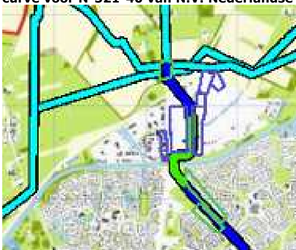
Figuur 4.5 Kilometer leiding behorende bij de maximale overschrijding van de FN-curve voor N-521-40 van N.V. Nederlandse Gasunie
