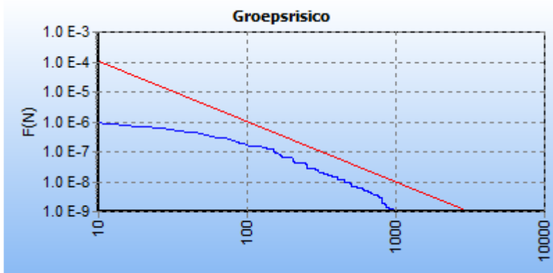
5.6 Figuur 5.6 FN curve voor NAM_000142 van Nederlandse Aardolie Maatschappij BV voor de kilometer tussen stationing 13770.00 en stationing 14770.00
