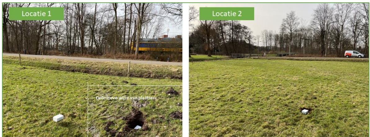
Figuur 3 Foto's Geplaatste trillingsmeters meetsessie 1
