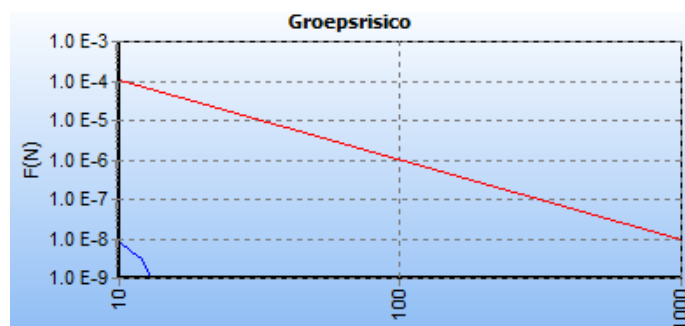
Figuur 5.4 : fN-curve van het berekende groepsrisico met de oriëntatiewaarde (rode lijn)
