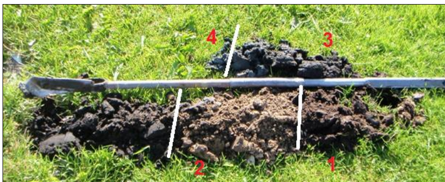
Afbeelding 12. Foto van boring 2 waarbij 1: bouwvoor, 2: opgebrachte grond, 3: eerdgrond, 4: keileem
