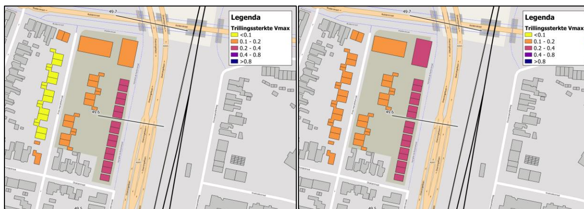
Figuur 7 Trillingssterkte V_{max} per bouwblok, links voor concept I, rechts voor concept II
