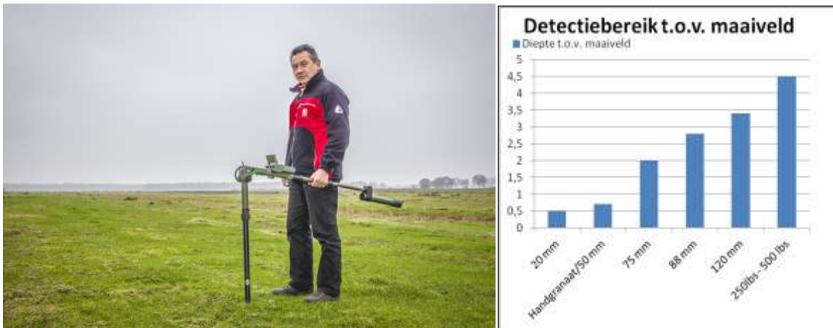
Figuur 2: Uitvoeren passieve analoge oppervlakedetectie m.b.v. Vallon VX1 ferrous locator en maximale detectiediepte van verschillende CE artikelen.
