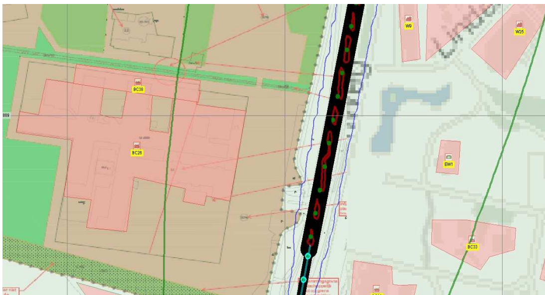
Figuur 4.2 Ligging 10^{-8} contour (groene lijn) ten opzichte van de uitbreiding van het Wilhelmina ziekenhuis
