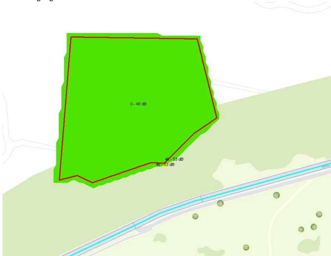
Afbeelding 4.1 rekenresultaten vanwege Burgemeester van Leusdenweg 9,75 m, inclusief aftrek ex artikel 110g Wgh
