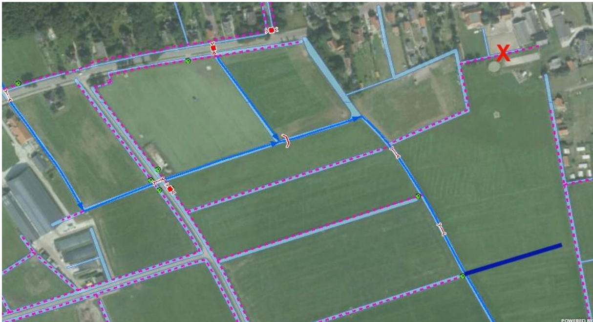
Figuur 5.7 Locatie van de verplaatste schouwsloot en compensatie waterberging. In rood de gedempte sloot, in blauw de nieuwe sloot
