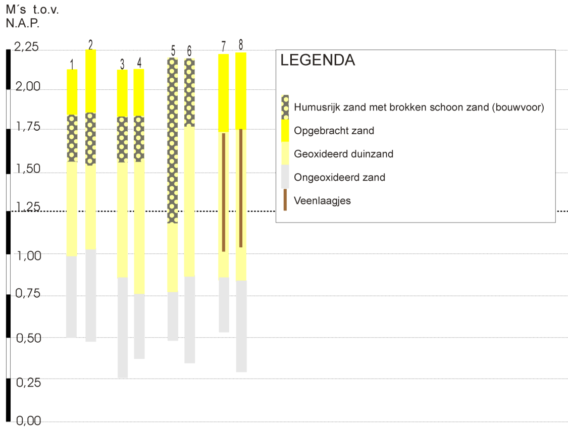
Figuur 8. Hoorn, Dorpsstraat 20. Weergave van de resultaten van het booronderzoek in de vorm van boorprofielen.
