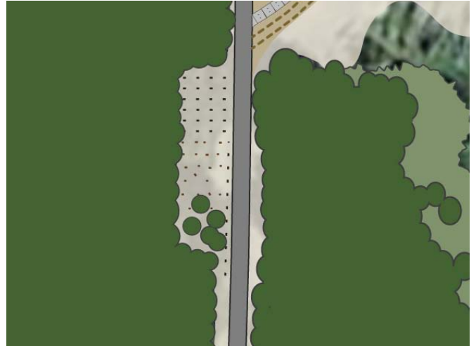
Afbeelding 12 aanvullen bestaande fietsenstalling met houten paaltjes
