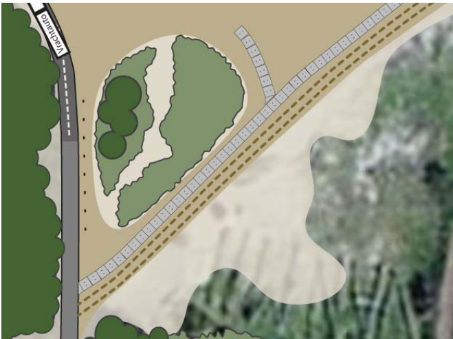
Afbeelding 11 wandel- en fietspad stelconplaten
