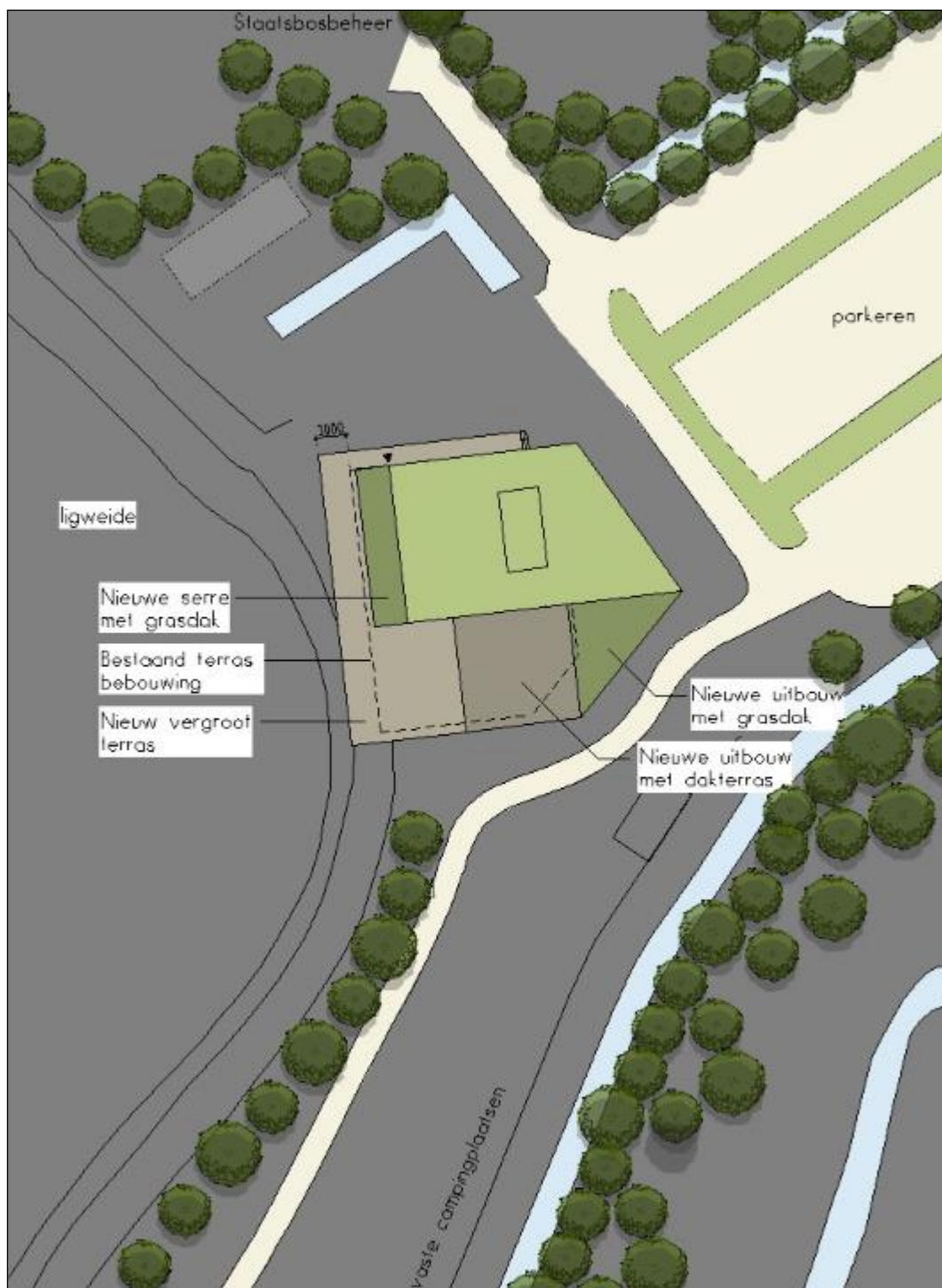
Figuur 1.2. Uitbreidingsplannen Paviljoen de Leyen te Rottevalle. Bron: ARTEC bouwkundig ontwerp & advies.
