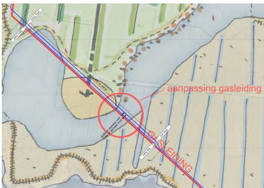
Figuur 3: verplaatsing bestaande en aanleg nieuwe aardgastransportleiding op ondergrond gebiedsontwikkelingsproject 'Oudega aan het Water'
