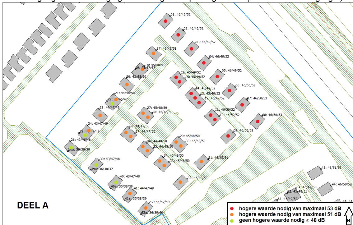
Afbeelding 4 geluidsbelasting t.g.v. autoweg N31 op deelgebied A (incl. aftrek art 110g wgh.)
