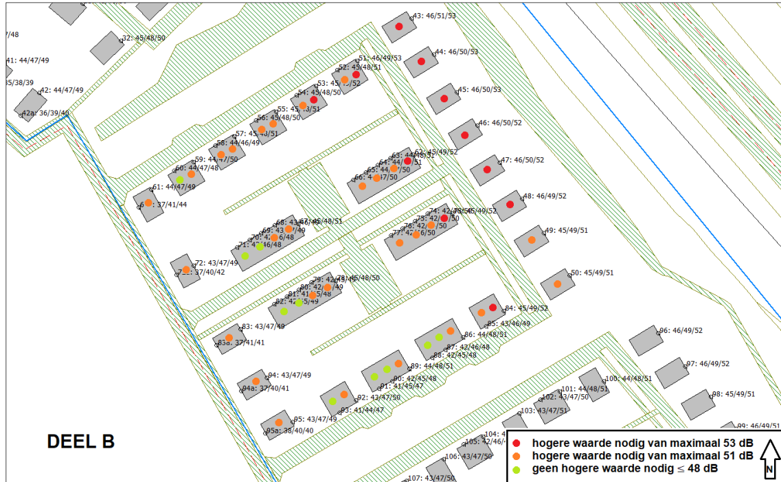
Afbeelding 5 geluidsbelasting t.g.v. autoweg N31 op deelgebied B (incl. aftrek art 110g wgh.)
