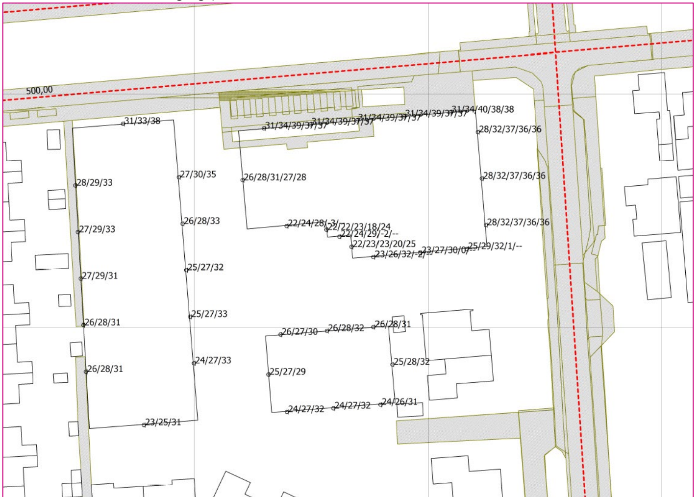
Figuur 5.1: overzicht van de berekende geluidbelasting L_{den} in dB vanwege De Lange West (inclusief 5 dB aftrek op basis van artikel 110g Wgh)
