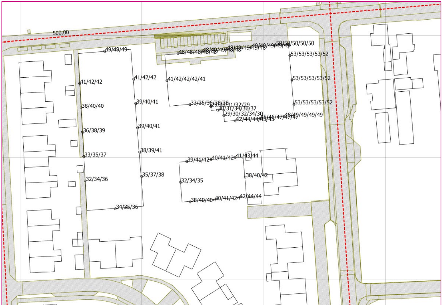
Figuur 5.3: overzicht van de berekende geluidbelasting L_{den} in dB vanwege de omliggende 30 km-wegen (inclusief 5 dB aftrek op basis van artikel 110g Wgh)
