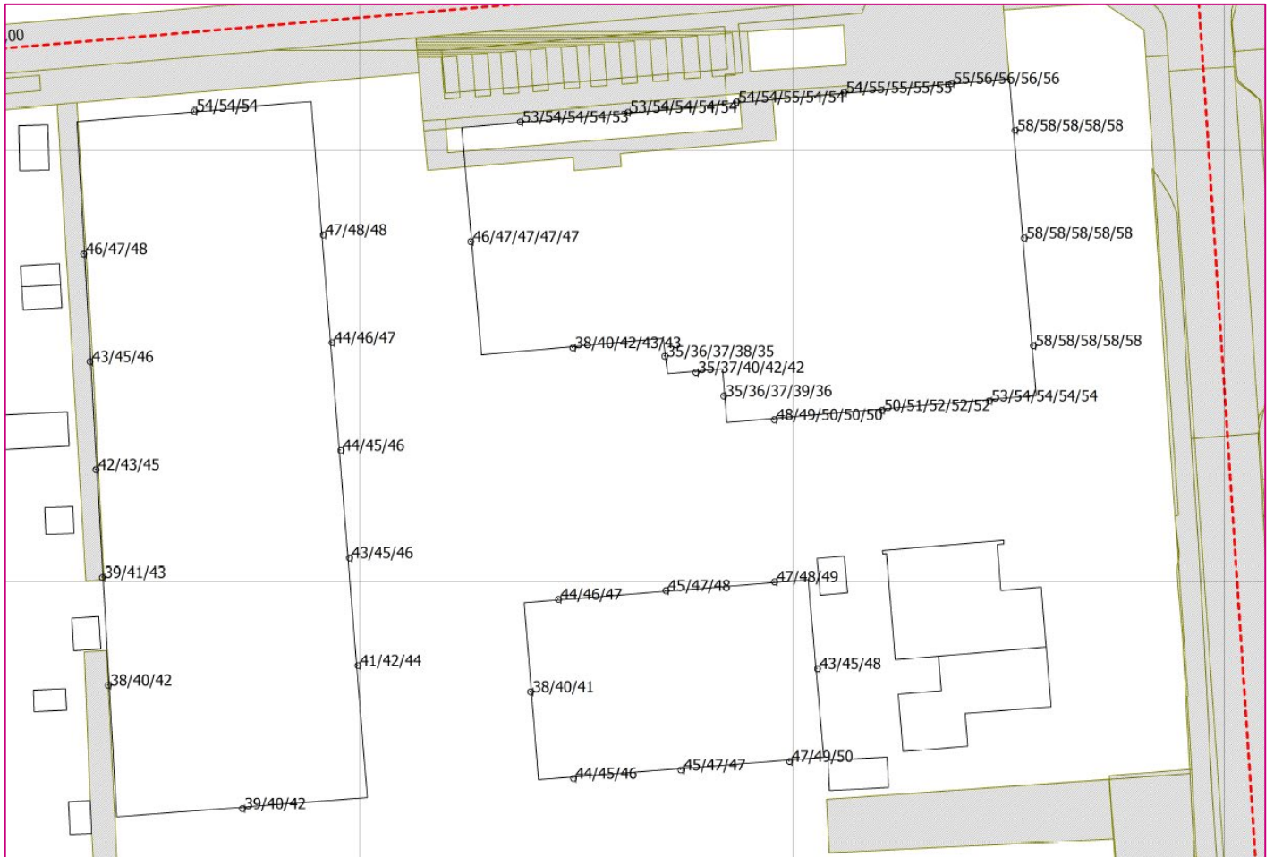
Figuur 5.4: overzicht van de berekende cumulatieve geluidbelasting L_{den} in dB (exclusief aftrek op basis van artikel 110g Wgh)
