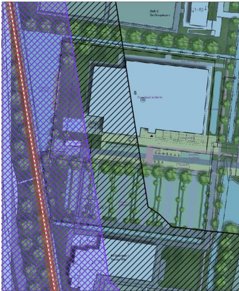
Figuur 3: Buisleiding (rood gestippeld), belemmeringenstrook (bruin gekleurd), invloedsgebied 1% letaal (zwart gearceerd) en 100% letaalgebied (paars gearceerd).
