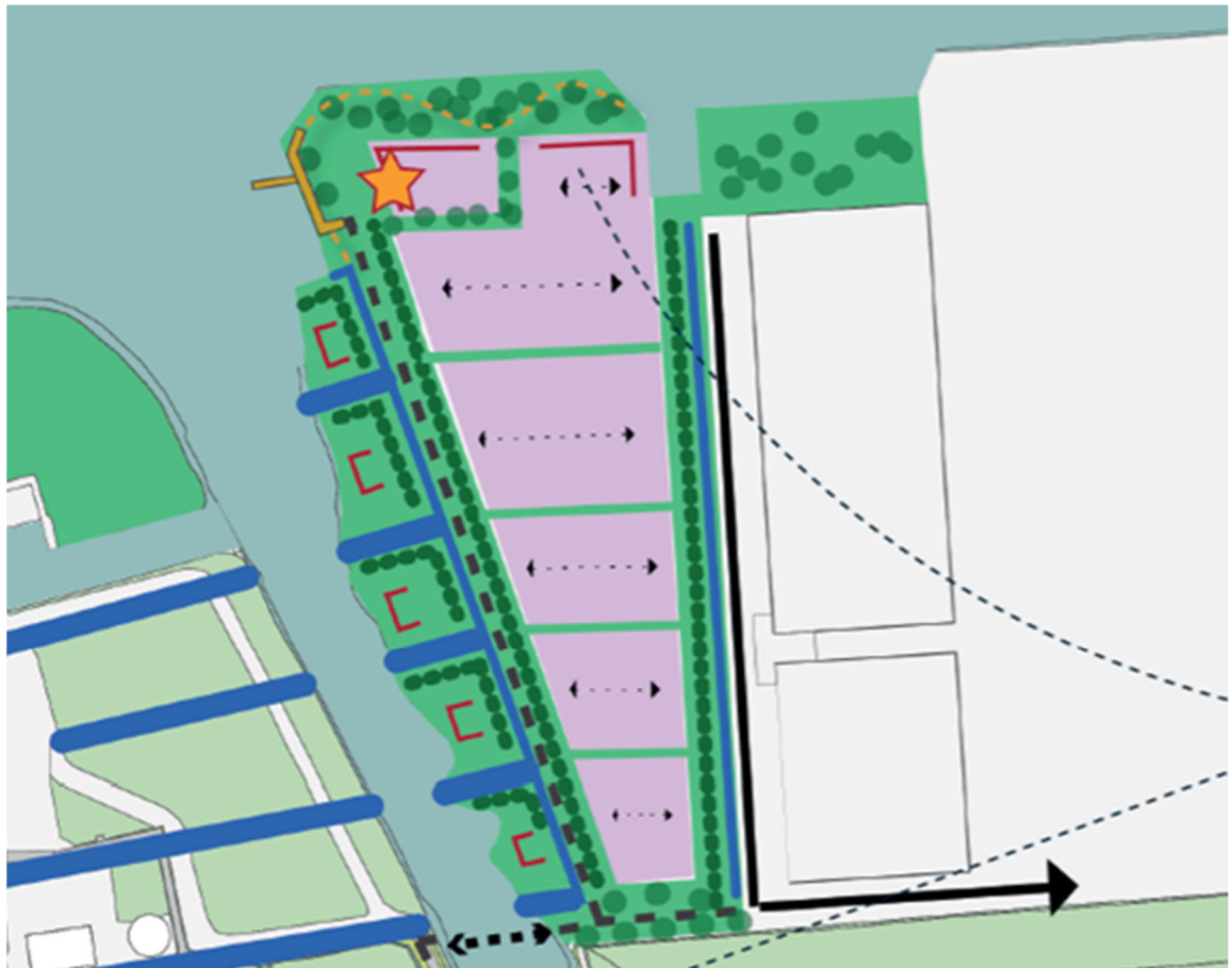
Afbeelding 2.10. Een ontwerp van de beoogde situatie. Vijf woon/werk kavels met naastgelegen watergangen.
