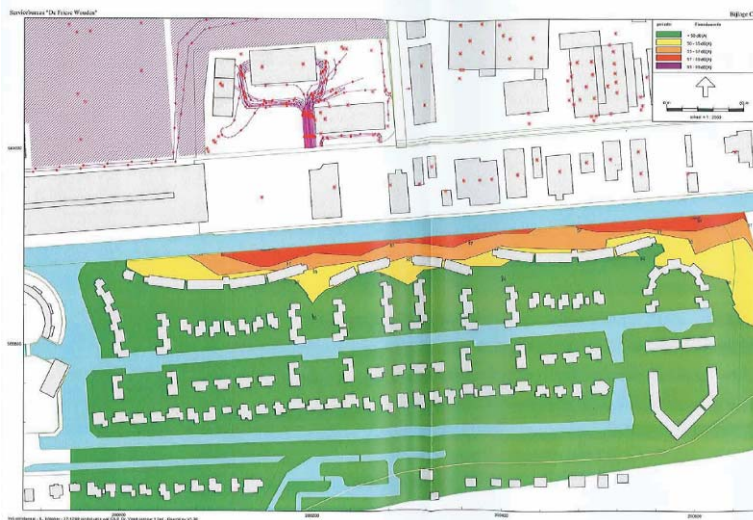
Afbeelding 11: cumulatieve geluidsbelasting industrielaawaai op 1,5 m hoogte
