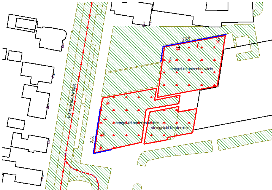
Figuur 3.1 Overzicht mogelijke geluidafscherming schoolpleinen
