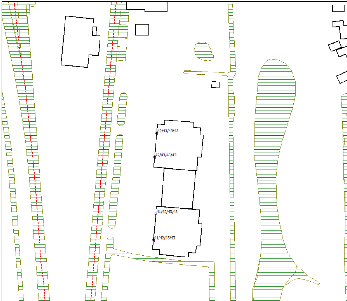
Figuur 5.2: overzicht van de berekende geluidbelasting L_{den} in dB vanwege de Commissieweg (inclusief 5 dB aftrek op basis van artikel 110g Wgh)
