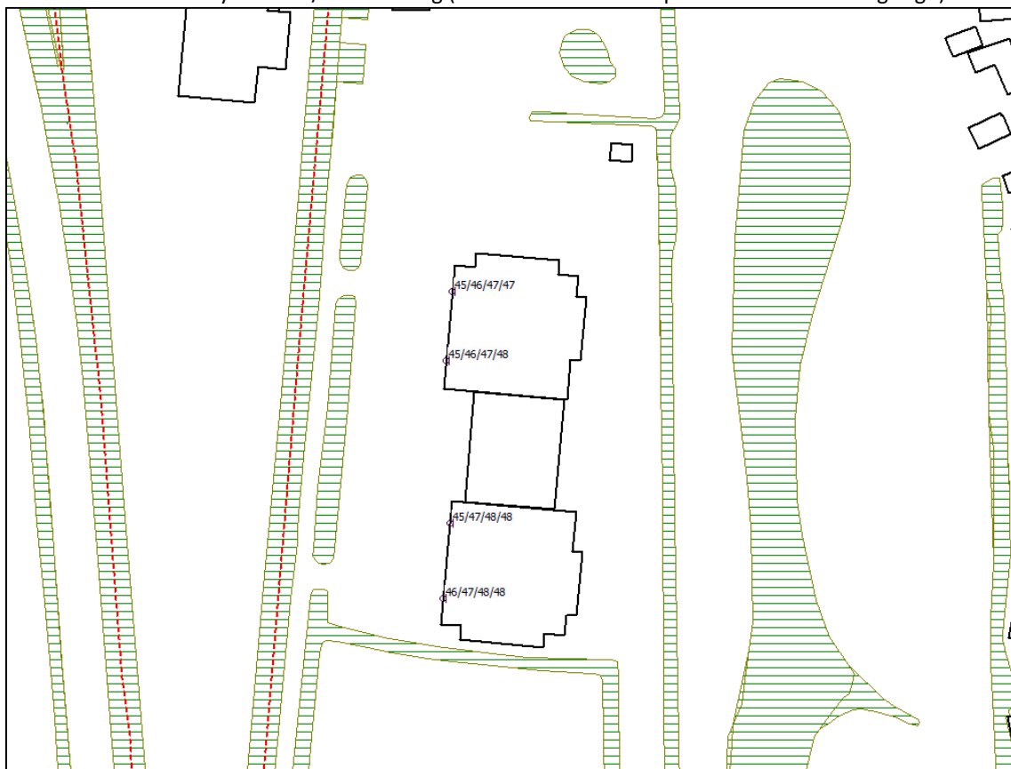
Figuur 5.1: overzicht van de berekende geluidbelasting L_{den} in dB vanwege de Gerdyksterwei/Beetsterweg (inclusief 5 dB aftrek op basis van artikel 110g Wgh)
