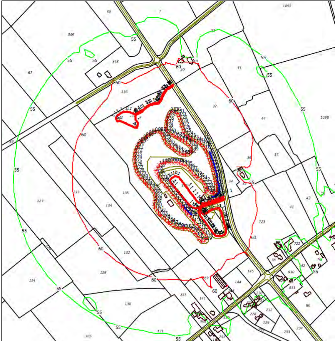
Figuur 7.8: overzicht van de berekende geluidcontouren als langtijdgemiddelde beoordelingsniveaus L_{A,r,LT} in de dagperiode (waarneemhoogte h_0 = +1,5 m) – daggemiddelde tijdens A-wedstrijden
