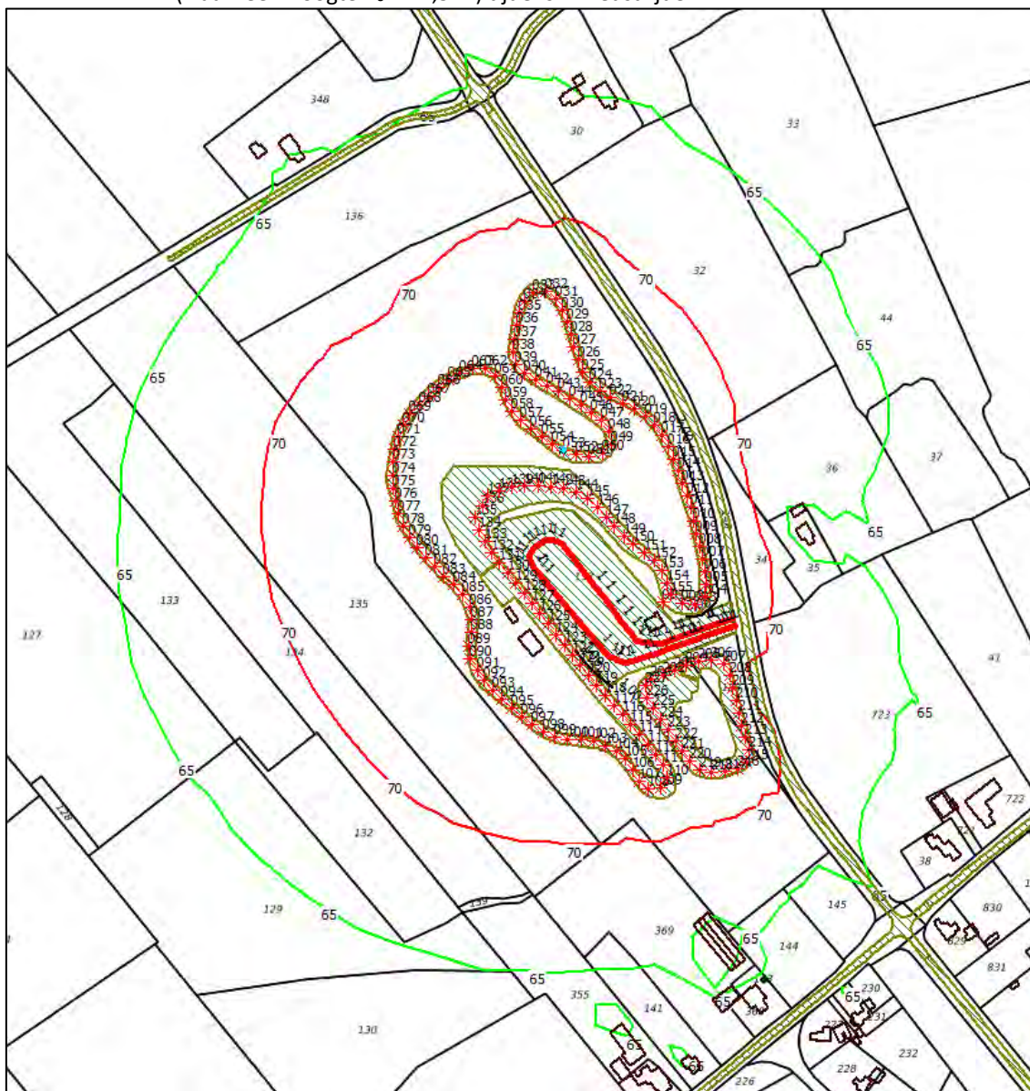
Figuur 7.7: overzicht van de berekende geluidcontouren als maximaal te meten immissieniveau L_i (waarneemhoogte h_o = +1,5 m) tijdens B-wedstrijden
