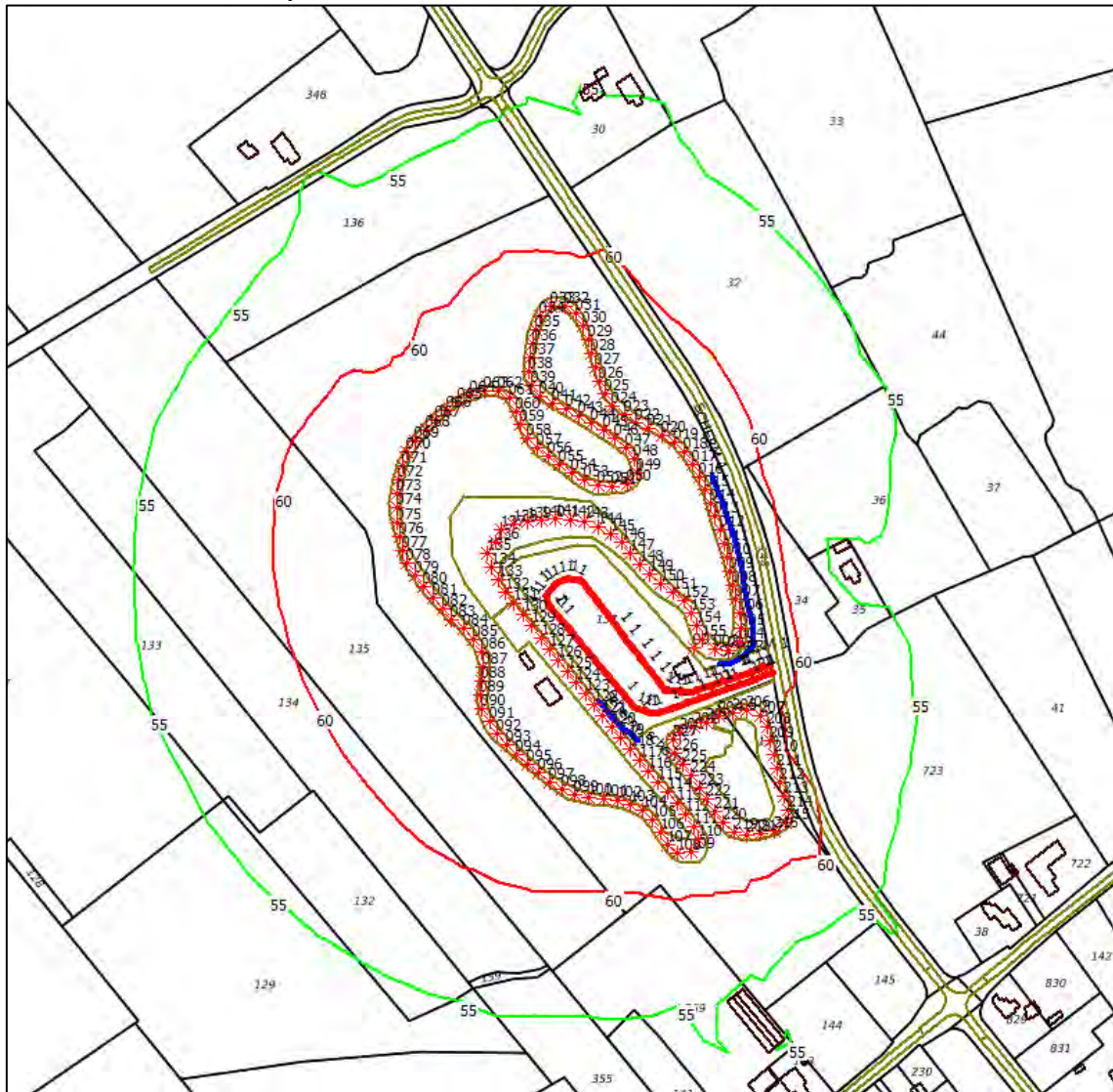
Figuur 7.6: overzicht van de berekende geluidcontouren als langtijdgemiddelde beoordelings-Niveaus L_{A,r,LT} in de dagperiode (waarneemhoogte h_o = +1,5 m) – daggemiddelde tijdens B-wedstrijden
