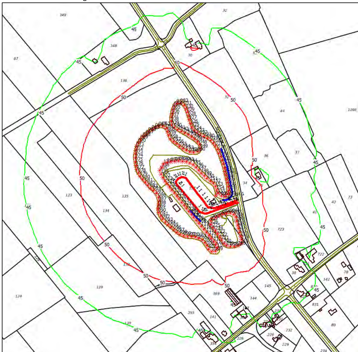
Figuur 7.4: overzicht van de berekende geluidcontouren als langtijdgemiddelde beoordelingsniveaus L_{A,T,LT} in de dagperiode (waarneemhoogte h_o = +1,5 m) – daggemiddelde tijdens trainingen
