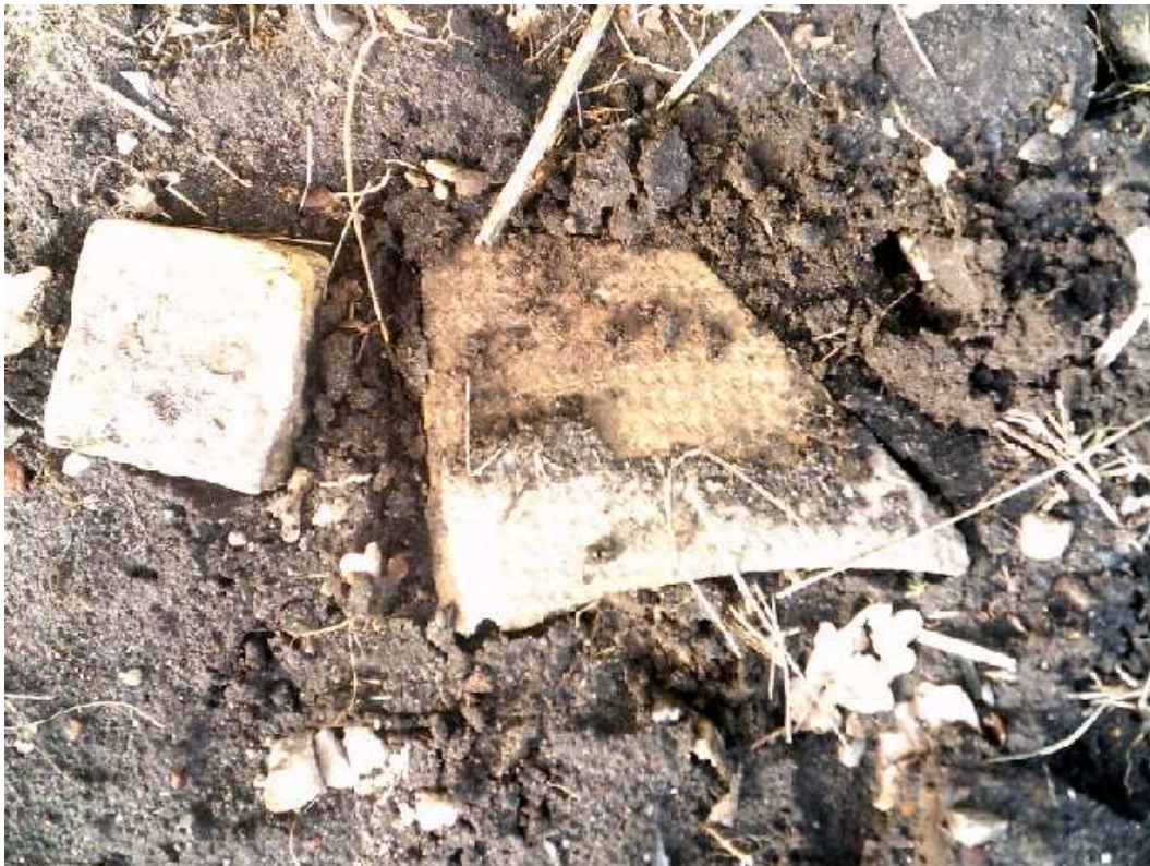
Foto 16. Wester Es 48, Appelscha asbestverdachte materiaal op maaiveld
