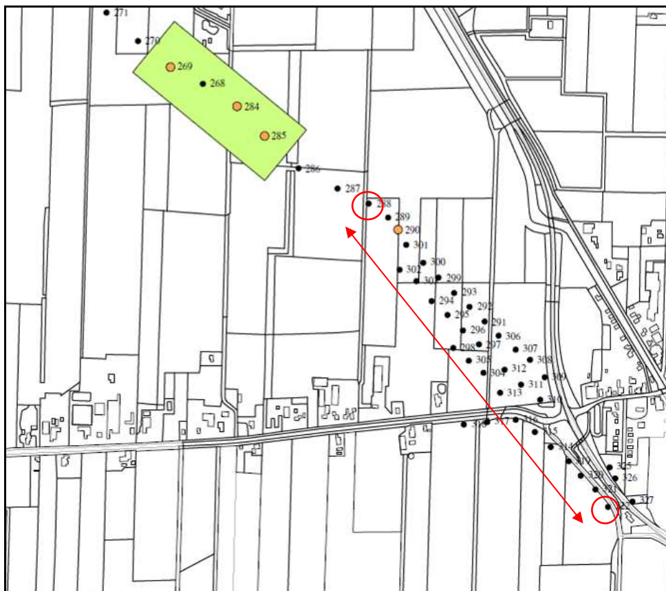
Afbeelding 7: Situatietekening met boorlocaties N381 Donkerbroek (bron: ARC-rapport 2006). Het boorprofiel (zie afbeelding 8) door het rivierdal staat aangegeven met cirkels rond boring 288 aan de noordwestkant en boring 322 aan de zuidoostkant.
