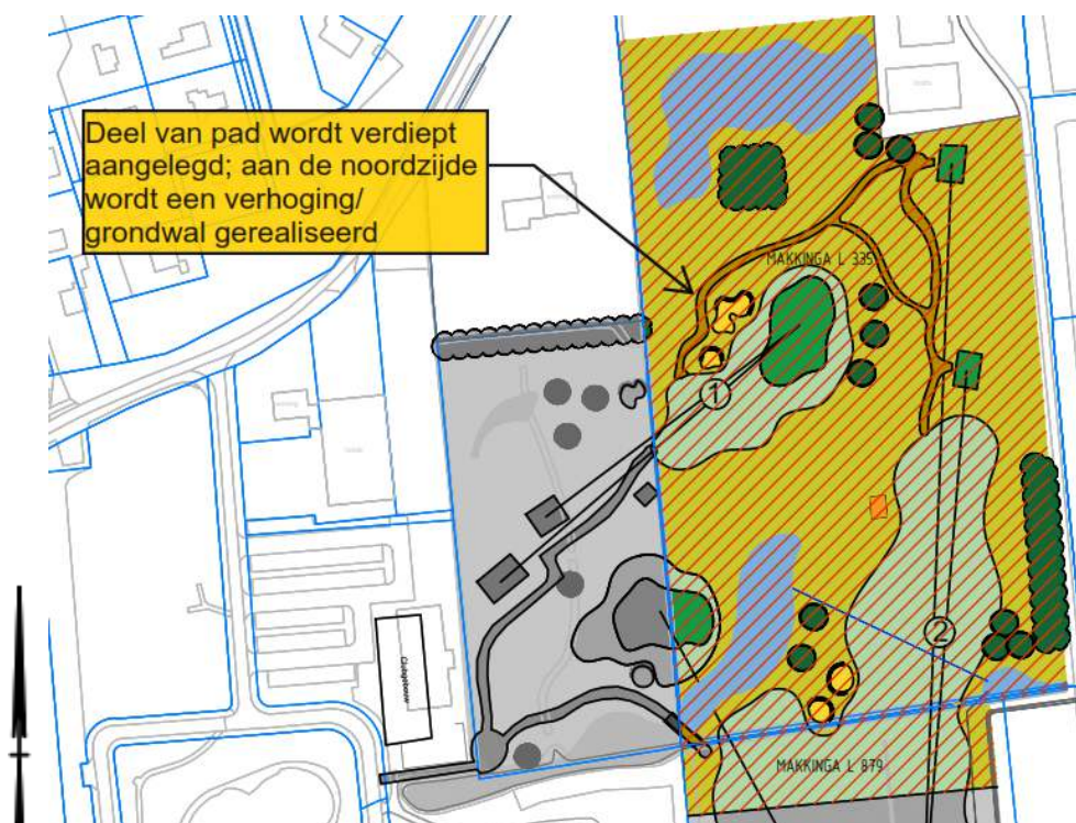
Afbeelding 5.1 Pad dat deels verdiept wordt aangelegd
