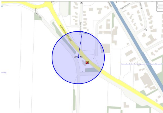
Figuur 8: RO contour (110 m) gerekend vanaf het vulpunt, bij een doorzet ≥ 1000
