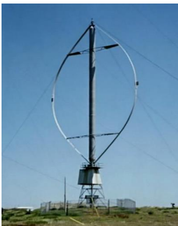
Windturbine van het zgn 'Darrieus-type'
