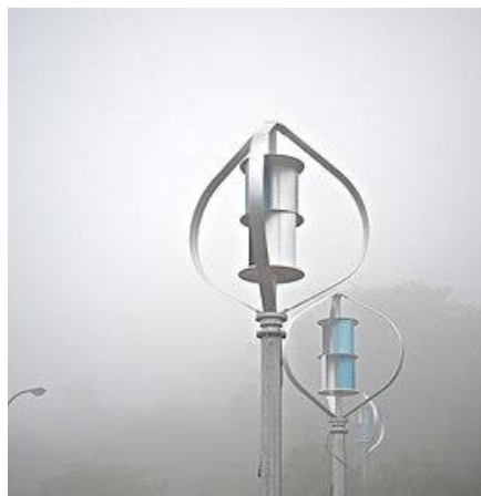
Windturbine van het zgn 'Savonius-type'
