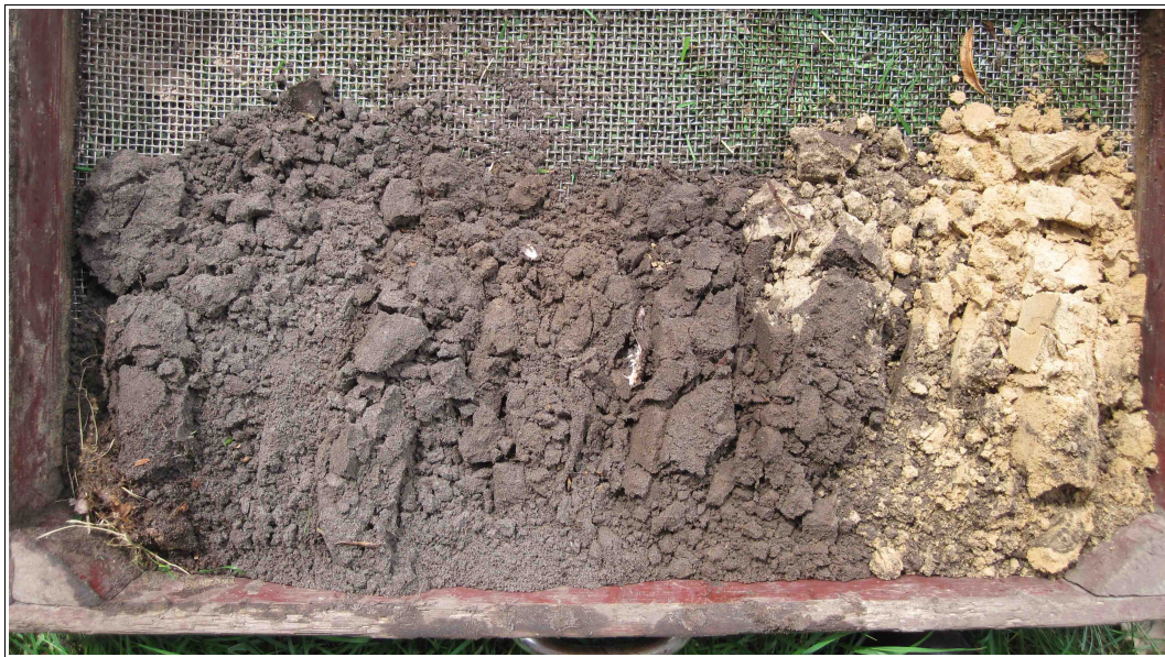
Figuur 10: Oldeberkoop, Wolvegasterweg 10: monster boring 5. In de zeef ligt het zand van drie lagen: links de bouwvoor (0-50 cm), midden de iets bruinere plaggenlaag (50-80 cm) en rechts het diepere gele zand (80-110 cm).
