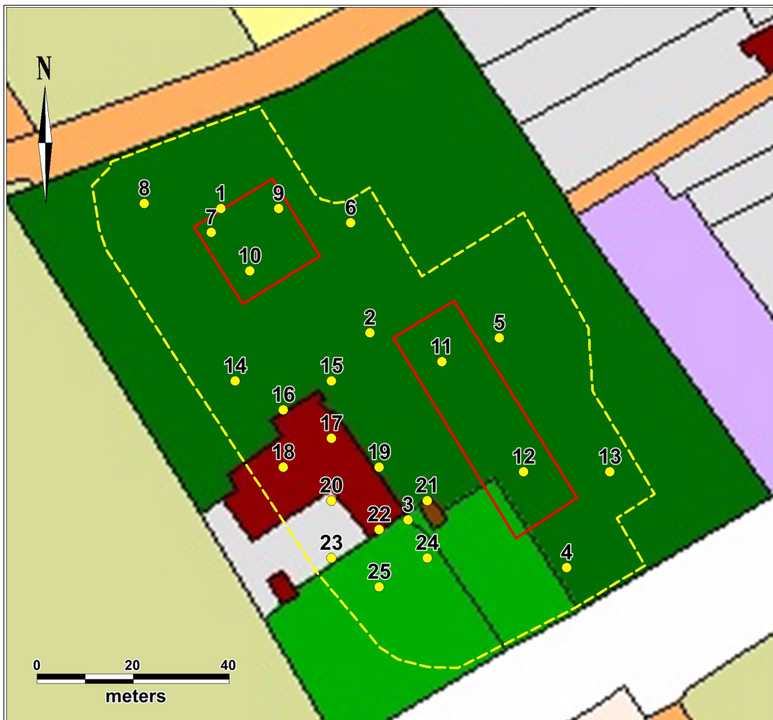
Figuur 3: Oldeberkoop, Wolvegasterweg 10: boorpuntenkaart. De genummerde punten zijn de locaties van de boringen. Boringen 1-7 zijn van het voorgaande onderzoek, boringen 8-25 zijn van het huidige onderzoek. De rood omlijnde terreinen zijn mogelijke locaties voor de nieuwbouw. Als achtergrond is een interpretatie van de kadasterkaart 1811-1832 gebruikt van www.hisgis.nl .
