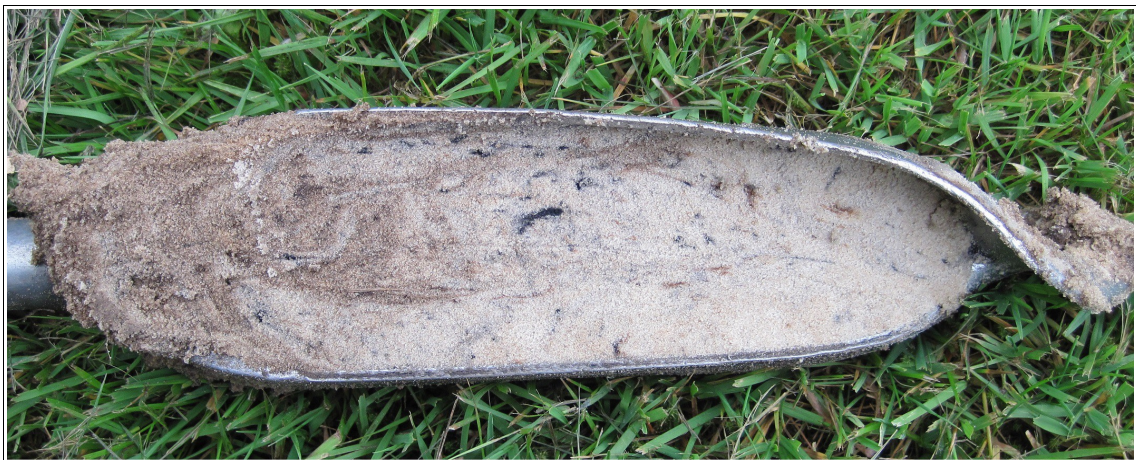
Figuur 4: Oldeberkoop, Wolvegasterweg 10: boorkop met monster van boring 21, 90-100 centimeter. De zwarte spikkels zijn houtskool.
