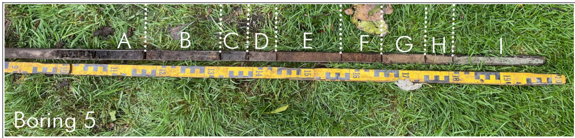
Figuur 19. Nijeberkoop, Bovenweg 23: Boring 5 met venige lagen, dekzand, keizand en keileem. Het sediment uit de onderkant van de guts (rechts) bevond zich op een maximale diepte van circa 200 cm -Mv. Met de hoofdletters zijn de verschillende grondlagen aangeduid. Van boven naar beneden: A = zwak zandig veen; B= klei mineraalarm veen, bosveen; C = kleiige veenlaag, smeerlaag; D = kleiige veenlaag, smeerlaag; E = sterk zandig veen; F = sterk siltig, matig fijn zand, lemig, met veel plantenresten; G = dekzand, zwak siltig, matig fijn zand, C-horizont; H = keizand, zwak siltig zand, matig grof met grind en I = keileem, sterk zandige leem met grind.
