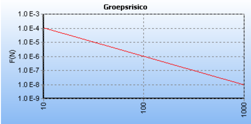
5.3 Figuur 5.3 FN curve voor N-501-41 van N.V. Nederlandse Gasunie voor de kilometer tussen stationing 0.00 en stationing 1000.00
