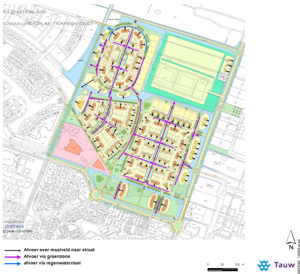
Figuur 6.4 Voorstel afvoer hemelwater
