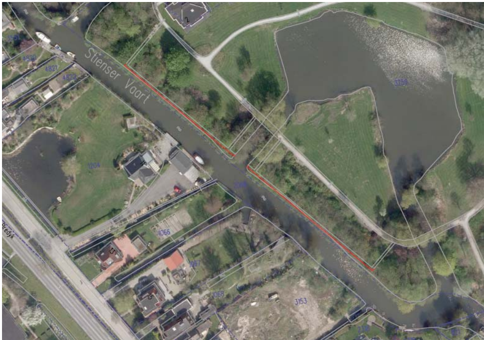
Figuur 3 Situatie aan te brengen damwand met bolders (rode lijn)
