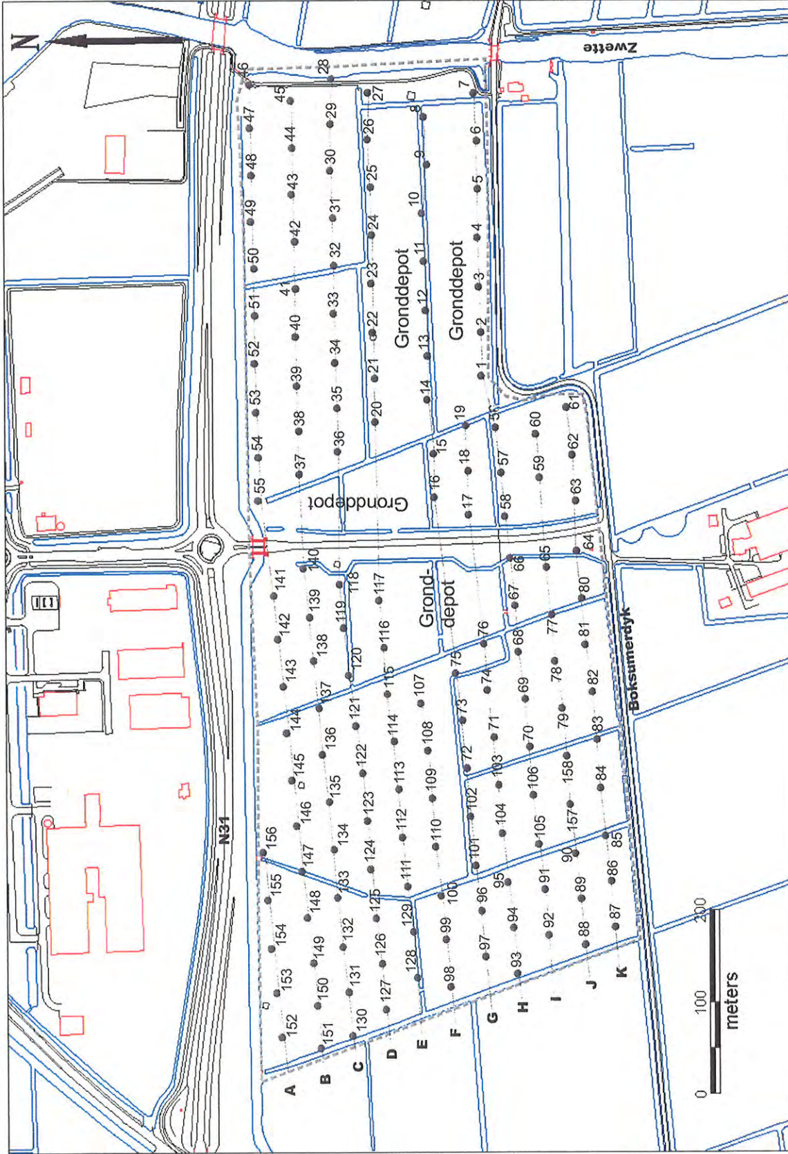
Figuur 5. Leeuwarden, Newtonpark IV; Boorpuntenkaart. De grijze onderbroken lijn geeft het plangebied aan. De genummerde punten geven de uitgevoerde boringen weer.
