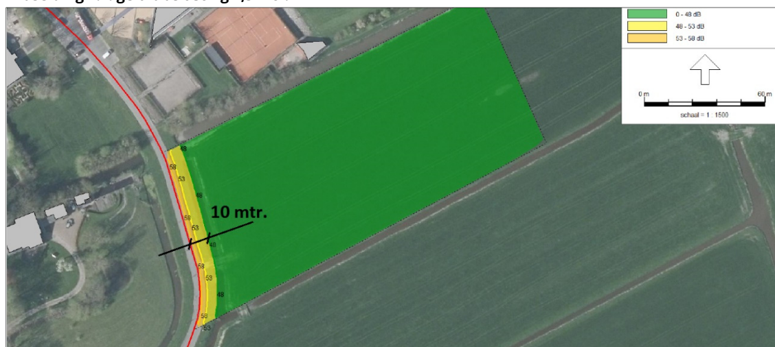
Afbeelding 4.1: geluidbelasting 1,5 mtr. +mv
