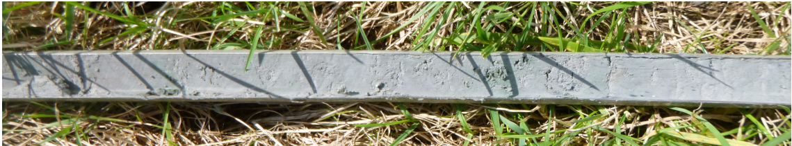
Figuur 6: Mantgum, Om 'E Terp: Foto van het pakket matig slappe klei met enkele dunne zandlaagjes zoals op alle boorpunten is aangetroffen.
