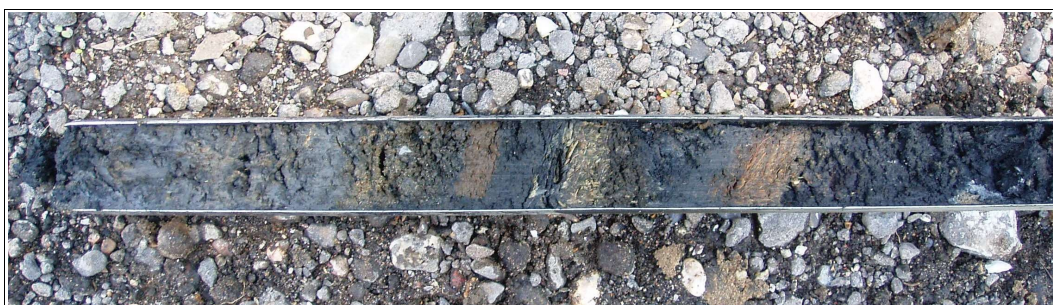
Figuur 5: Grou, Volmaweg: monster boring 2 van 1,4 (links) tot 1,0 (rechts) meter beneden maaiveld. De rechter 0,3 meter is slootvulling met veenlagen, de linker 0,1 meter is onderliggende klei.
