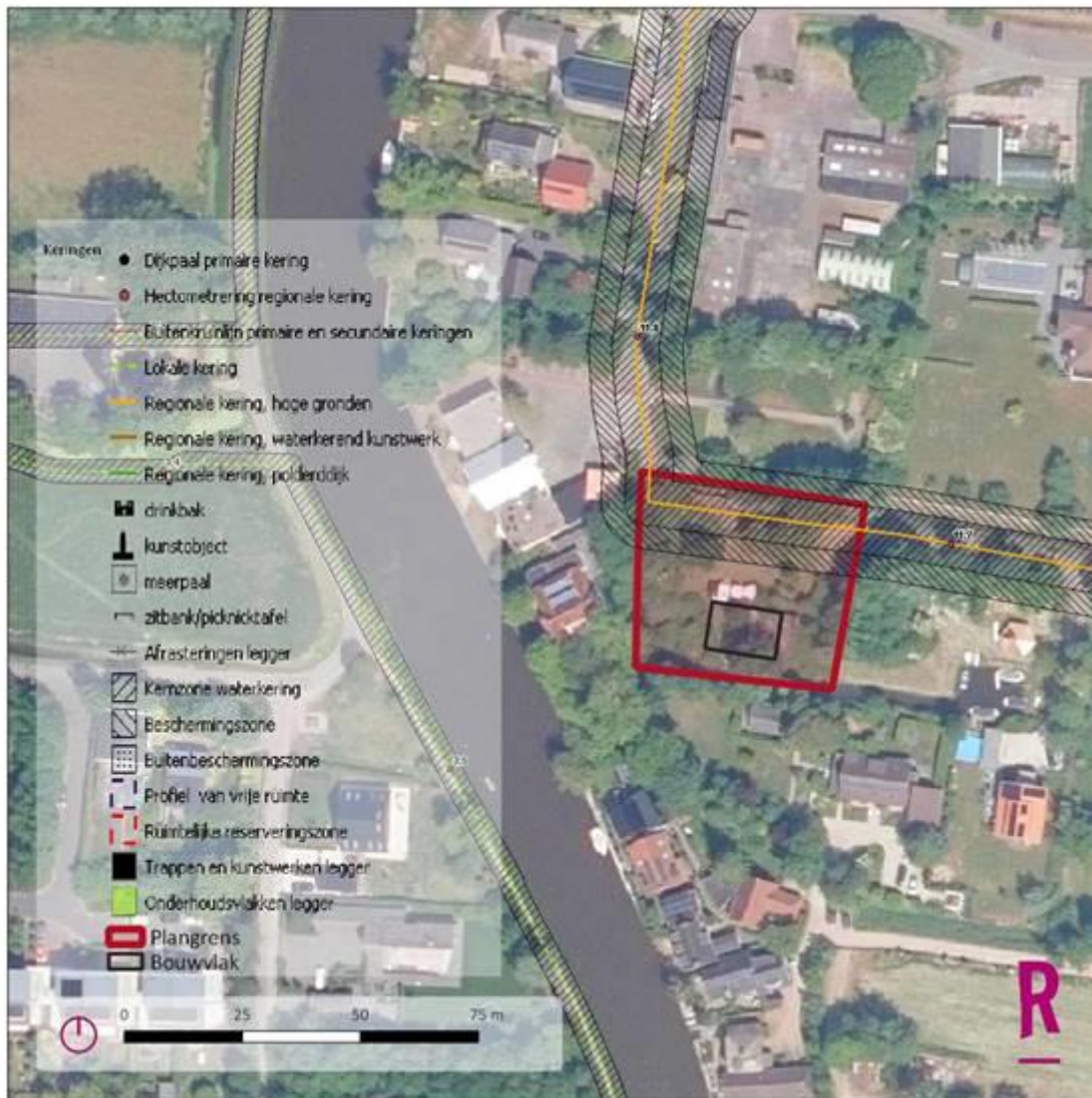
Figuur 4.1 Ligging van het plangebied en het bouwvlak met de waterkering en bijbehorende beschermingszone
